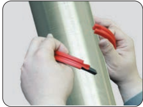
1. Öffnen des Dichtringes, Um die Welle installieren
