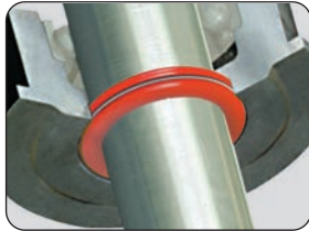
4. Austausch der alten Dichtung, Verschluss nach oben
