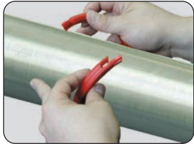
1. Öffnen des Dichtringes, Um die Welle installieren
